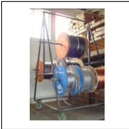
Figura 1: suporte para as bobinas de cabos
