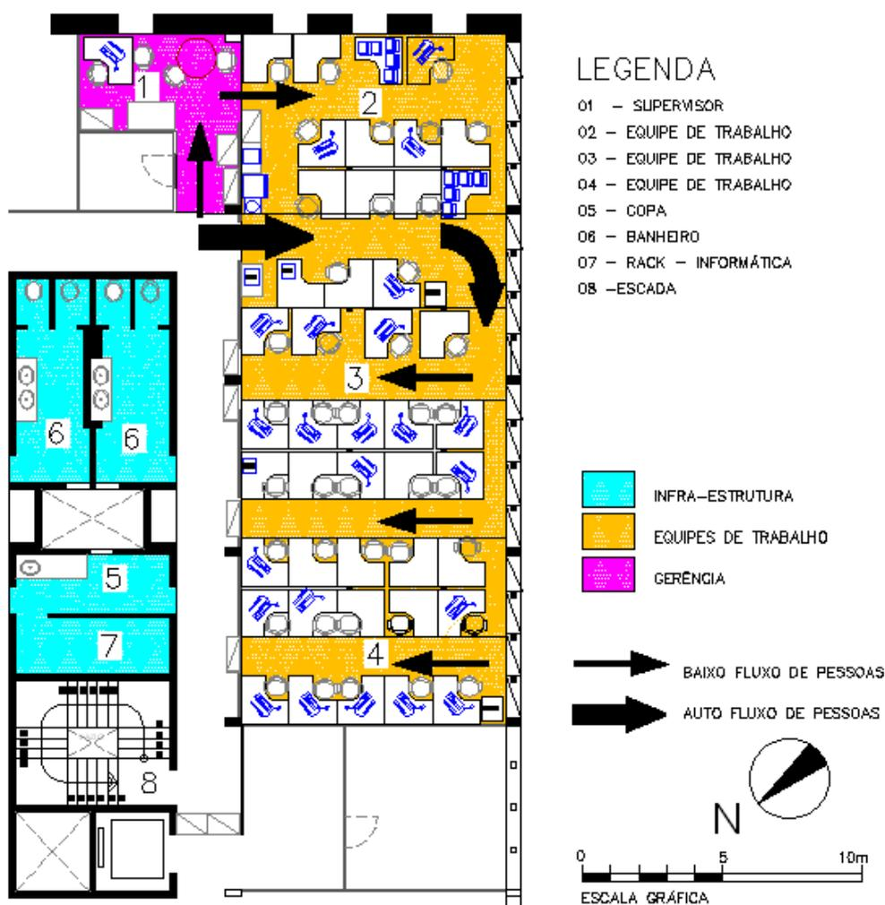
**Figura 10 – Planta de fluxos.**
