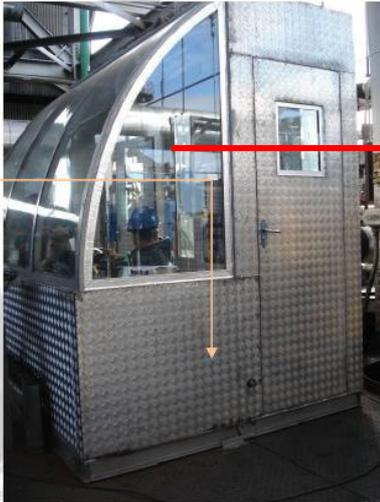
Cabine de referência A demonstrando a curvatura do vidro e o ângulo de visão do operador de dentro da cabine.
