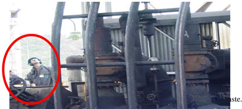
Devido às condições de visualização deficiente de dentro da cabine, o operador acompanha a maior parte da atividade do lado de fora, onde o campo visual é mais eficiente. Porém o nível de ruído se intensifica na parte exterior, pois no interior da cabine são 90 decibéis (aberta) e em torno de 88 (fechada), na parte externa próximo ao
