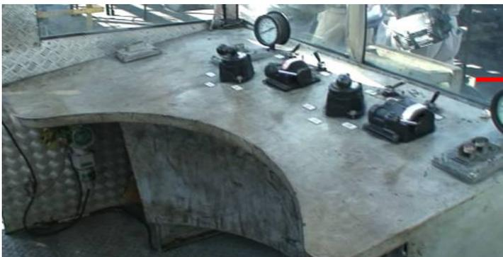
Painel na posição horizontal, com as alavancas de comando respeitando zona de alcance do operador.
