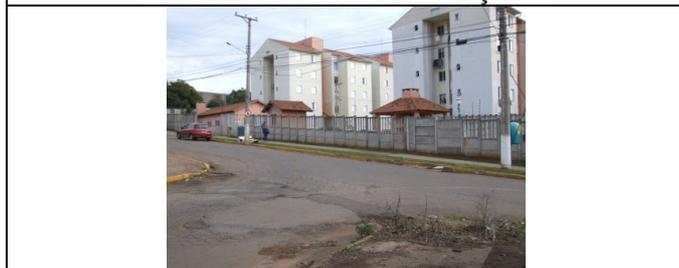
Nas calçadas em locais com faixa destinada a travessia de via pública por pedestre, não há rebaixamento do meio fio e rampa sobre a calçada, desta forma não há faixa de circulação, não continuidade de piso e a existência de obstáculos na travessia se dá das condições da rua. Bem como é inexistente a faixa de segurança.
