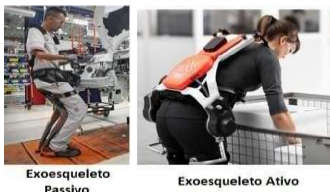
Figura 4 – Comparação entre execução de trabalho do Exoesqueleto Passivo e Ativo
