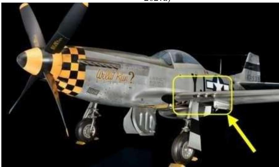
Figura 3 - Abertura das metralhadoras nas asas do P-51D
