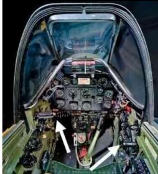
Figura 2 - Cabina de un P-51D. Las flechas muestran el acelerador (izquierda) y la manija de apertura del capó (derecha)
