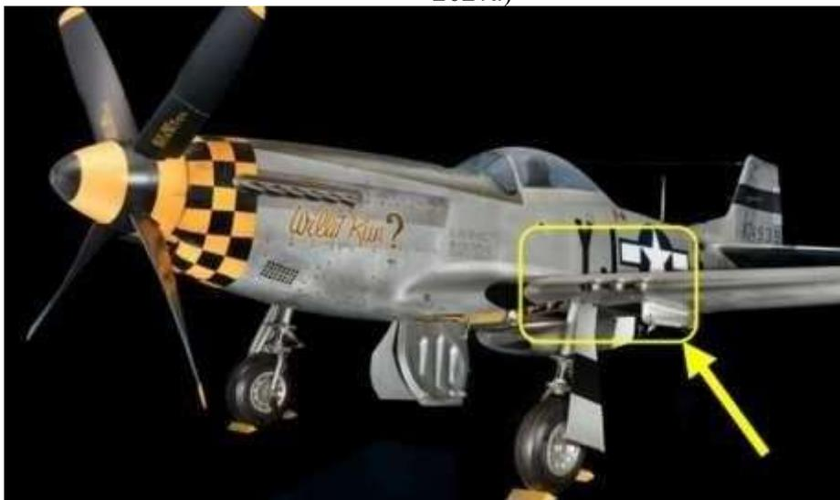
Figura 3 - Apertura de la ametralladora en las alas del P-51D
